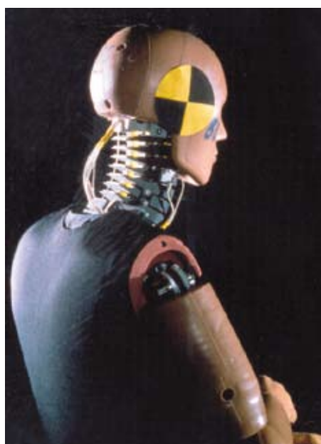
Krockdockan BioRID har tagits fram just för att testa effekten av påkörningar bakifrån. Bild från Fordonssäkerhet, Chalmers tekniska högskola.
