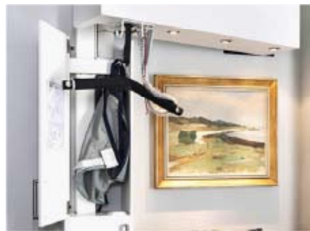
Personlyft som är dold i ett skåp när den inte används.
