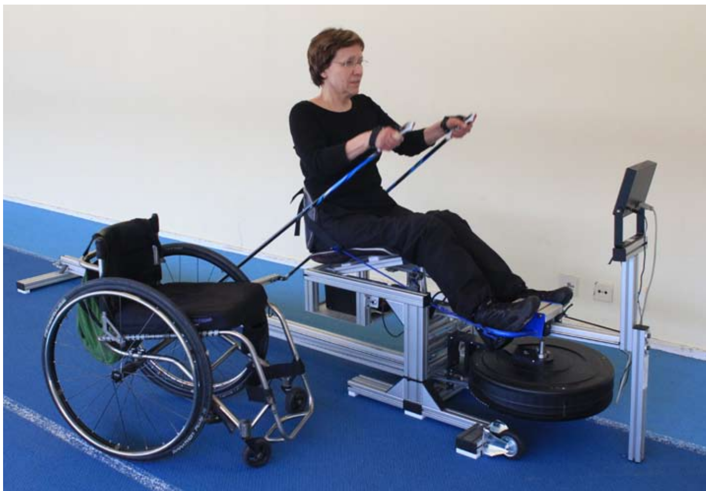
Sittstaksergometern är utformad så att det ska gå lätt att ta sig från rullstolen till sitsen och tillbaka. Det går att justera träningsredskapet på en rad olika sätt för att få optimal träning utan att belasta fel. Här är det Ulla Löfquist, instruktör på RG Aktiv Rehabilitering på Bosön, som kör ett pass. Foto: Mats-Erik Bjerkefors.
