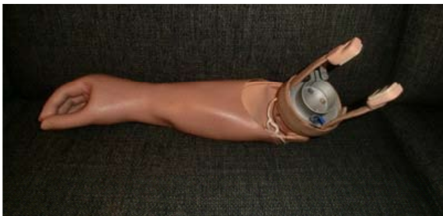
Min nya el-protes. På "antennerna" sitter elektroderna som skickar signalerna från mina muskler till armbåge och hand.
